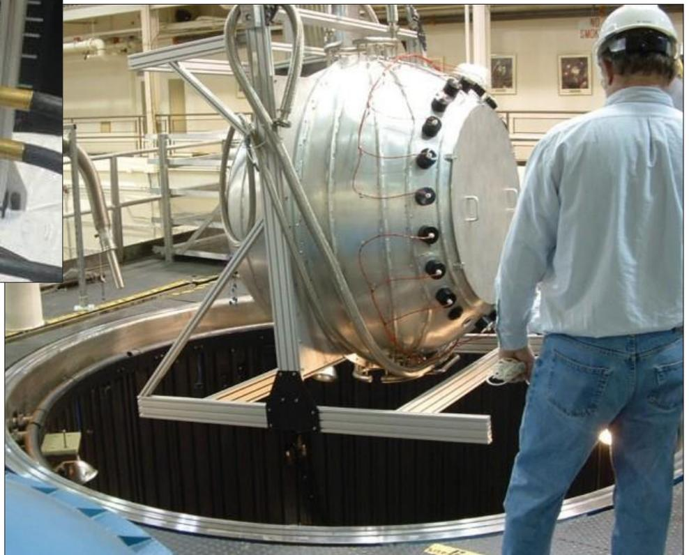
真空用1.5m LN2制冷式、8KW绝对均匀光源
